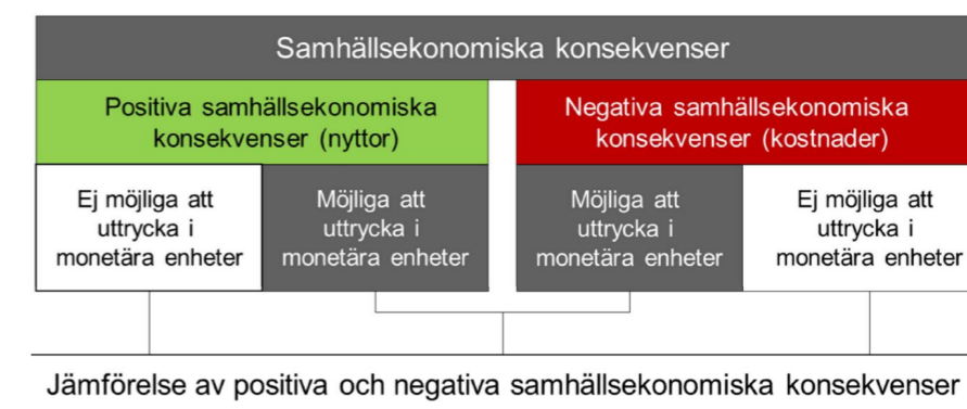
Figur 90. Principiell beskrivning av jämförelse av positiva och negativa samhällsekonomiska konsekvenser i en kostnads-nyttoanalys.
